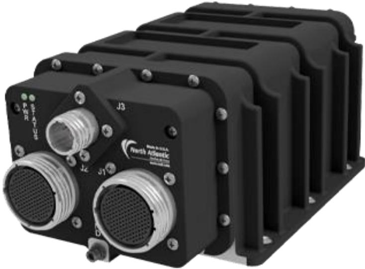
アクチュエーターインターフェースユニット (AIU) システムは、温度、流量、レベル、圧力などを示すさまざまなセンサーを結びつける中心的な役割を果たします。これらのモジュラーオープンシステムアプローチ (MOSA) システムは、ACリファレンス、LVDT、可変リラクタンس、熱電対、RTDを含む幅広い種類の機能で利用できる異なるアナログおよびデジタル入力と出力モジュールを特徴としています。NAIの堅牢なAIUシステムは、DO-178CおよびDO-254認証ソリューションを提供し、-40°Cから71°Cまでの耐久性を備え、MIL-STD-1275DおよびMIL-STD-704A (50 msecホールドアップ (電源)、MIL-STD-461FおよびMIL-STD-810G) に適合しています。
